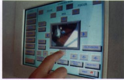
▲ Technik im Verborgenen: Hinter einer eleganten Glasschiebetür verbergen sich die Steuerung, der Musikserver, die Multiroomverstärker und verschiedene Zuspieldquellen. Mit dem drucksensitiven Monitor läßt sich unter anderem die Überwachungskamera im Schwimmbad steuern
