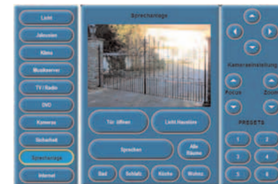
▲ Einbautouchpanel mit Videoansicht der Türüberwachung
